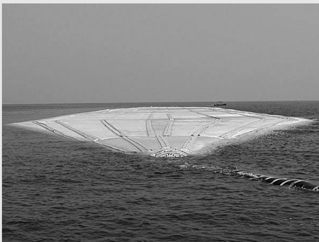
図6 水バッグを用いた水輸送の状況
