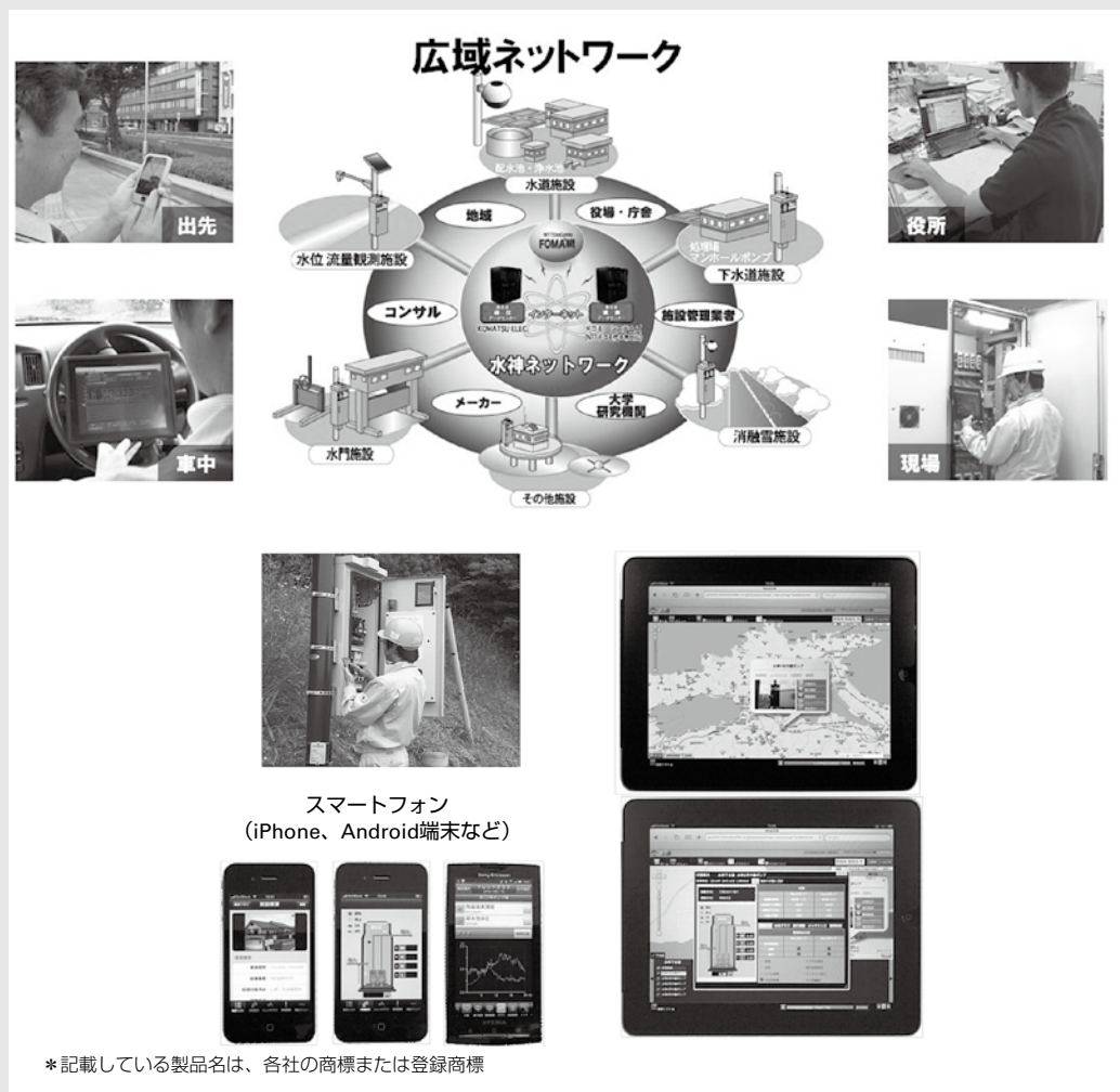
図4 「やくも水神Gシリーズ」に見るICTを活用した水インフラ施設の広域的管理
