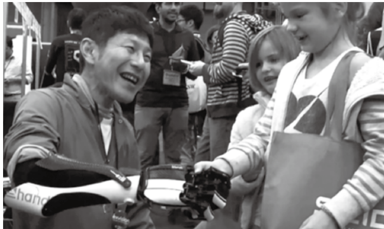
※写真の筋電義手は、スマートフォンでの皮膚信号判別や3Dプリンター製造によって、製造コストを大幅に抑制するという特徴がある 写真提供) イクシー株式会社 http://exiii.jp/index.html
