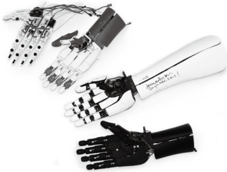
写真7 筋肉の電気信号を読み取って操作できる筋電義手
