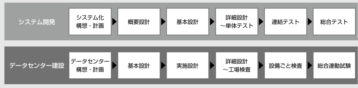
図2 システム開発とデータセンター建設工事における工程の類似性
