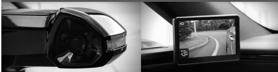
図3 「LEXUS ES」のデジタルアウターミラーと室内ディスプレイ
