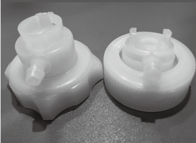
図13 キャップ形状変更(左が改善後のキャップ、右が従来型のキャップ)
