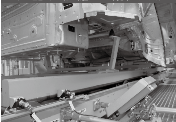
図2 ネッカーズルム工場の生産ラインを流れる車体に直接つけられているタグと生産ラインに沿って設置されている固定式リーダーライタ
