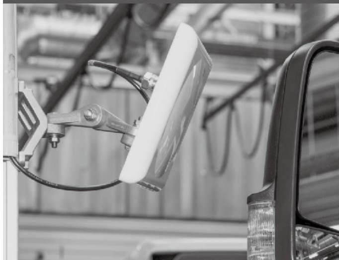
図5 ドアミラーのRFIDタグを読み取るために生産ラインに設置された固定式リーダーライタ
