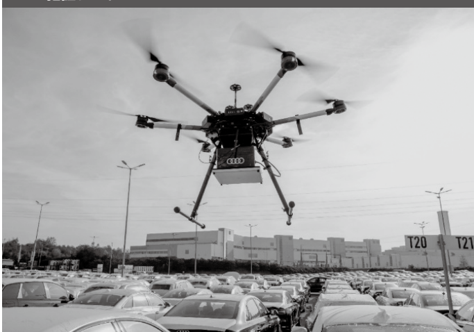
図3 ネッカーズルム工場の完成車ヤードで出荷前の完成車の位置を把握するドローン
