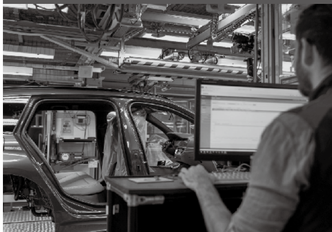
図6 車体に取り付けたカーシートのRFIDタグを読み取るために天井に設置された固定式リーダーライタ
