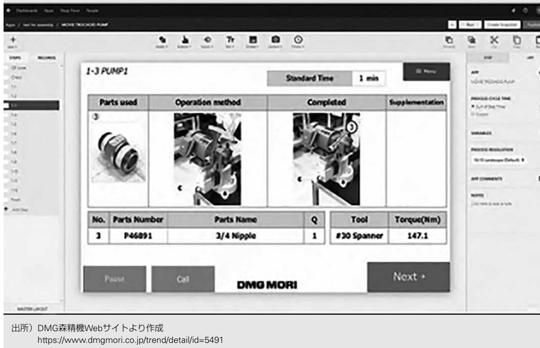
図10 DMG森精機における「TULIP」によるプログラミング不要のアプリケーション作成
