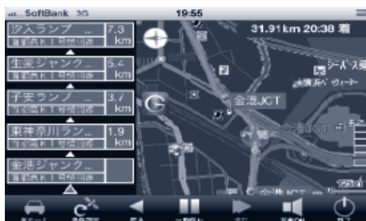
iPhone向け「全力案内！ナビ」の画面例。道路上に描画されている点線矢印がUTISプローブ情報
