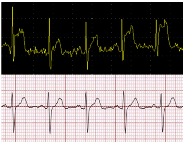
図2 ハンドルに測定端子を張り付けて測定した心電図(上)と同時に医療機器で測定した心電図(下)
