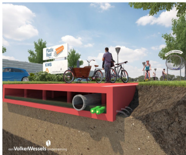
図5 オランダ フォルカヴェッセル社のプラスチックロード
