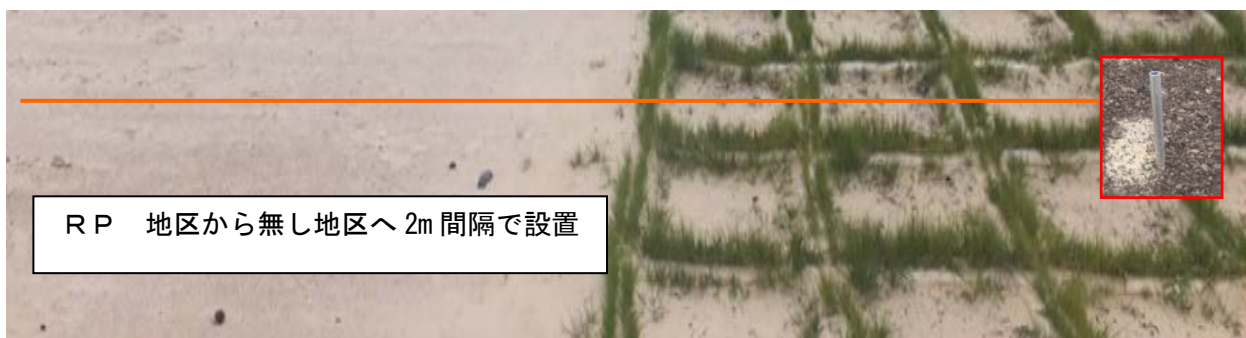
<写真 26 飛砂量計測棒の設置>
