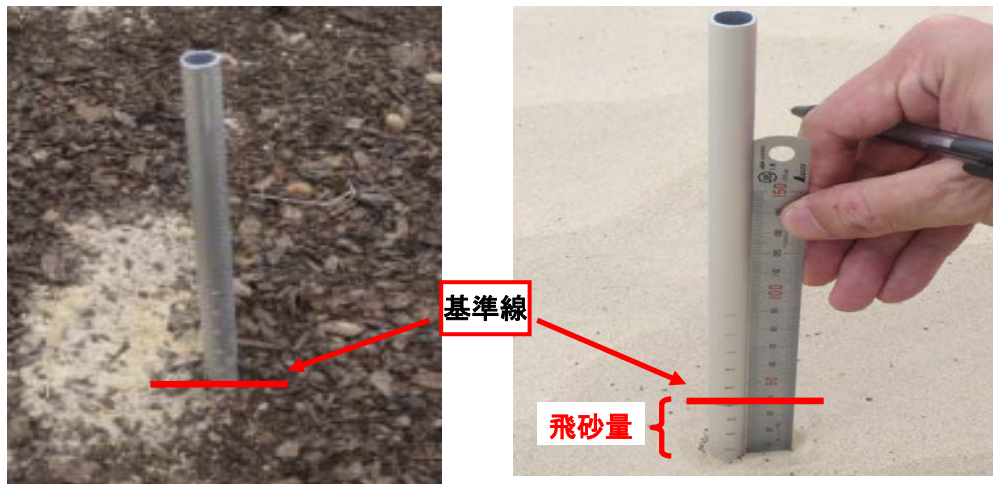
<写真 27 飛砂量計測棒 RP地区（左）、RP無し地区（右）>
