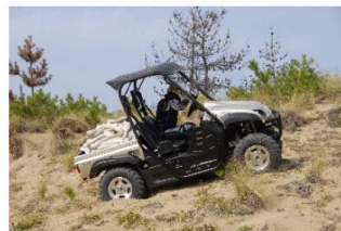
傾斜地での重荷による走行試験
