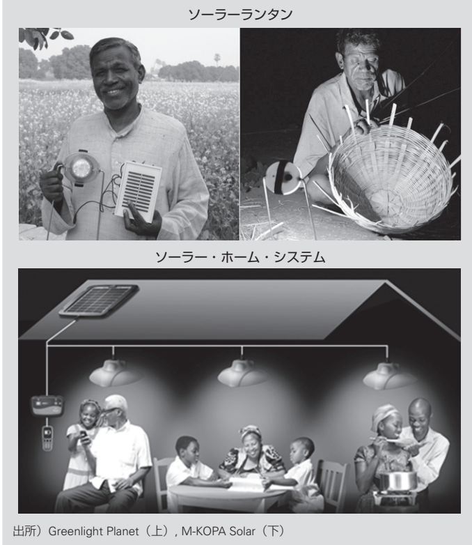
図1 ソーラーランタンとソーラー・ホーム・システム (SHS)
