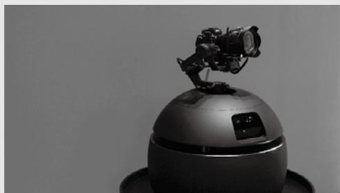
アーティストの動きに合わせて自律移動しながら撮影できる 移動カメラロボット
