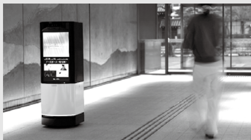
環境に合わせて速度変更・危険回避を行うガイドロボット 出所) ソニーグループ
