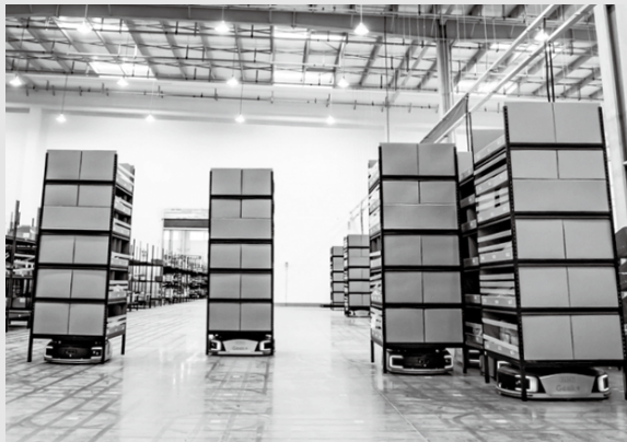
出所) 左: Geek+の棚搬送GTP 右: GROUNDのピッキングAMR
