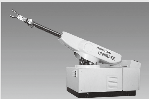
図5 国産初の産業ロボット「川崎ユニメート2000型」(左)と自動車工場での稼働(右)
