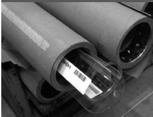
図9 レンゴーの新仙台工場で紙管につけられたRFIDタグの治具
