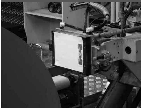
図5 生産された段ボール原紙のロールの側面に貼られるRFIDタグ
