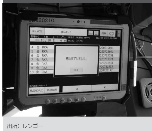
図7 トラックへの荷積みが指定通り完了した際のロールクランプリフトの車載端末の画面
