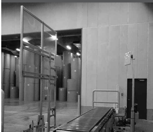
図6 コンベヤー上の段ボール原紙を自動的に識別する定置式RFIDリーダー
