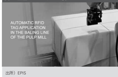
図2 生産されたパルプの梱へのRFIDタグづけ
