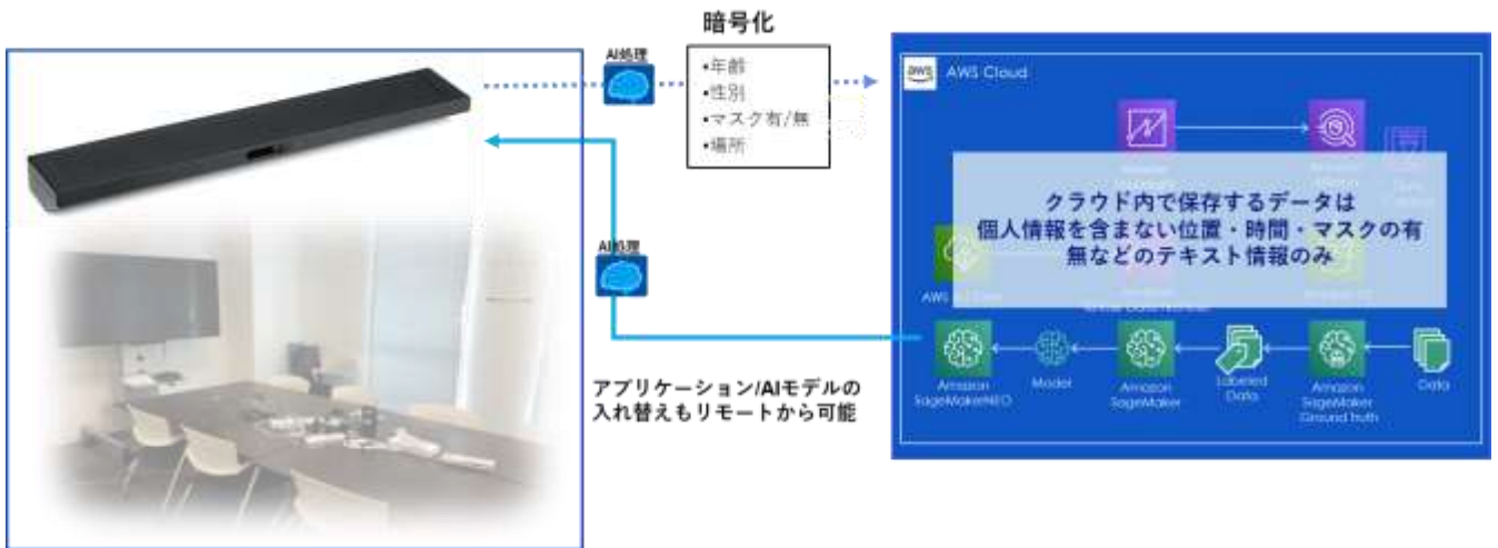
図：「NRI AI Camera」による AI 処理フロー
