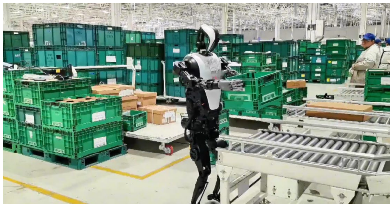
人型ロボット「夸父」はFAWグループの工場では箱運び作業を遂行
