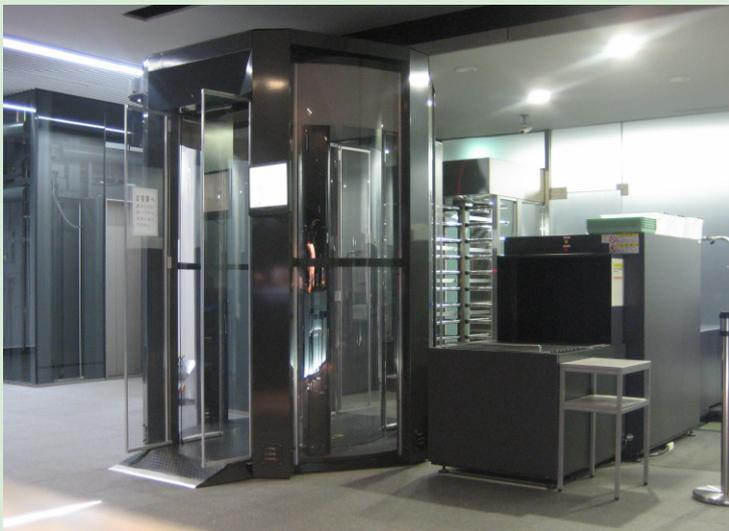
海外の空港などでテロ対策にも用いられている3Dホログラフィック・ボディスキャナーと、X線検査装置を使った入退館ゲート
